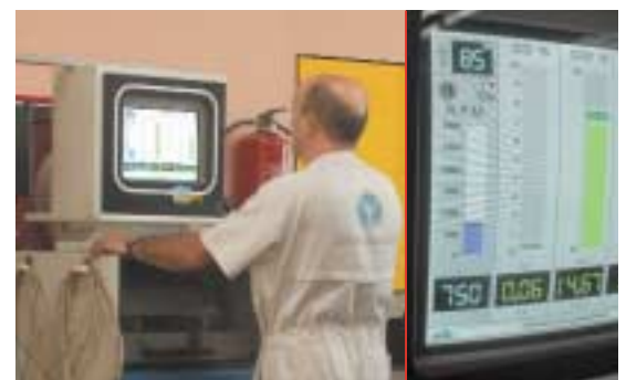
La prueba de medición de los gases de escape correcta debe realizarse a la temperatura de servicio del motor, es decir, que la temperatura del aceite del motor debe estar como mínimo a 60°C.
