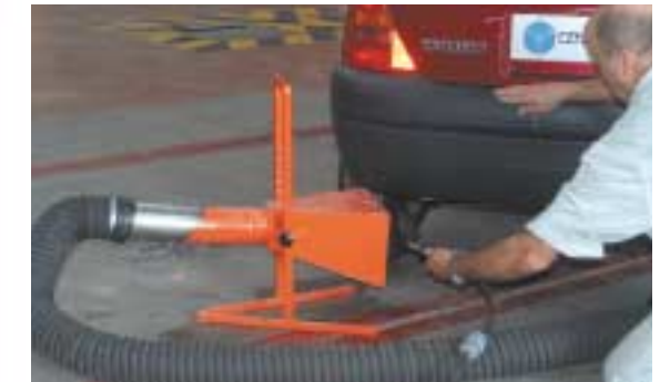
Introducir la sonda de medición del analizador de gases en la salida de la instalación de escape del automóvil.
