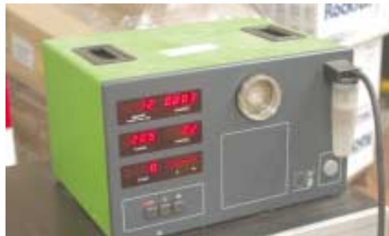
Equipo de control de emisiones: El equipo necesario para la medición debe ser un analizador de 4 gases y sonda lambda, homologado y calibrado según la legislación vigente.
