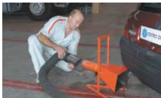
Posicionar el automóvil en el puesto de medición con el motor funcionando y conectar al escape el boquerel de aspiración de humos.
