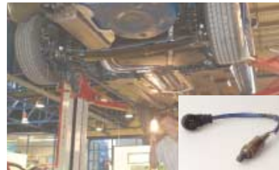
Inspección visual de la instalación de escape del automóvil a verificar: Comprobar que no existen perforaciones.
