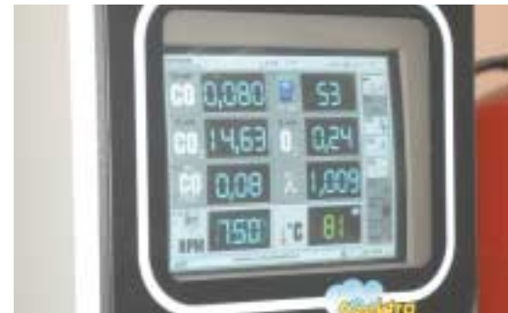
A ralentí, comprobar los valores de CO y valor lambda obtenidos en el analizador de 4 gases.
